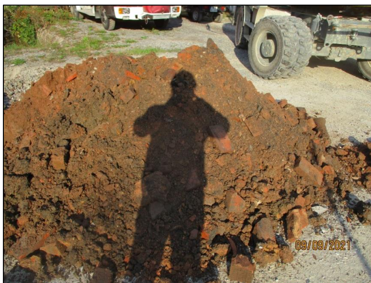
Abbildung 5-1: Baggerschurf 1, Gemisch aus Bodenmaterial und Ziegelbruch, ganze Backsteine und Ziegelbruchstücke
